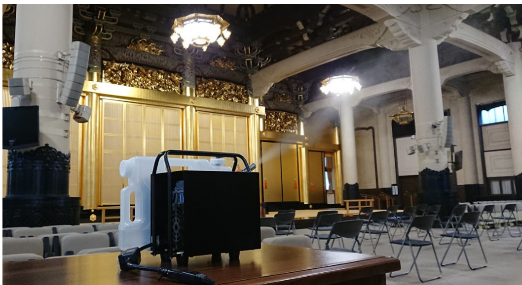
築地本願寺での施工の様子。GSE を空間放出して床に定着させる仕組み。超微粒子にした薬剤粒子は、ブラウン運動をおこし、自動的に拡散する。
